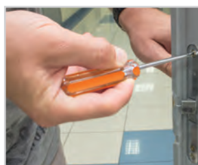
Удобство использования – рукоятки с углублениями и круговым рифлением в местах упора большого пальца.
