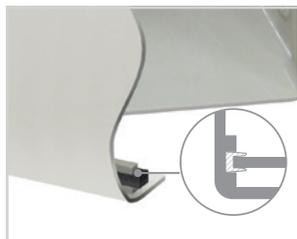
Степень защиты от воздействий окружающей среды IP65 достигается резиновым уплотнением.
