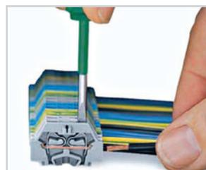
Надежная фиксация провода любого типа пружинным зажимом из стали с автоматической регулировкой усилия прижима в зависимости от сечения проводника.
