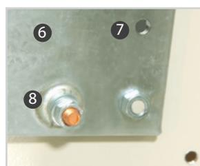
6. Оцинкованная монтажная панель 1,2 мм.
