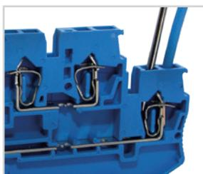
Надежная фиксация провода любого типа пружинным зажимом из нержавеющей стали с автоматической регулировкой усилия прижима в зависимости от сечения проводника.
