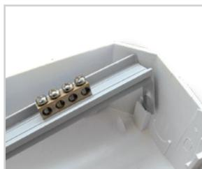
Специальная съемная рейка с шинами N, PE позволяет переставлять шину как в верхнюю, так и в нижнюю части бокса в зависимости от места подвода кабеля.
